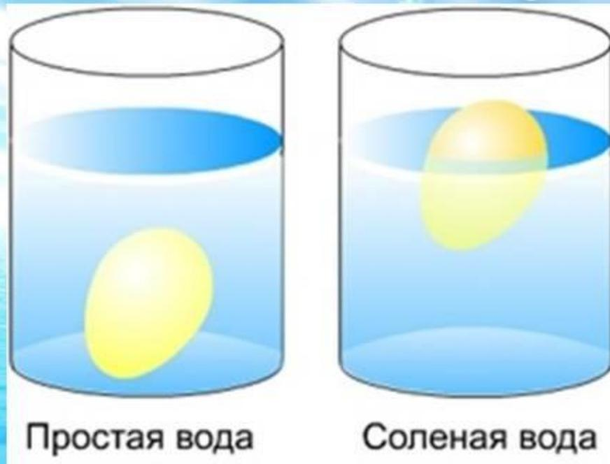
Подготовить два стакана – с соленой и пресной водой. Опустить по одному яйцу в каждый стакан. В стакане с пресной водой яйцо опустилось на дно, в соленой – всплыло. Вывод: В соленой воде легче плавать, потому что тело поддерживает не только вода, но и растворенные в ней частички соли.
